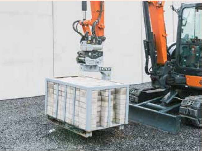
Automatischer 0°-Niveauausgleich Hält die Last automatisch waagrecht dank KTEG Zero Level Automatic System.
