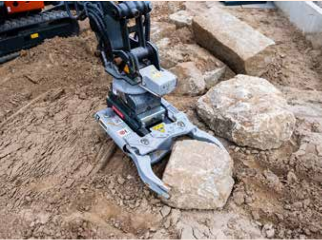
Kontrolliertes Platzieren Setzt Steine und andere Objekte präzise ab.
