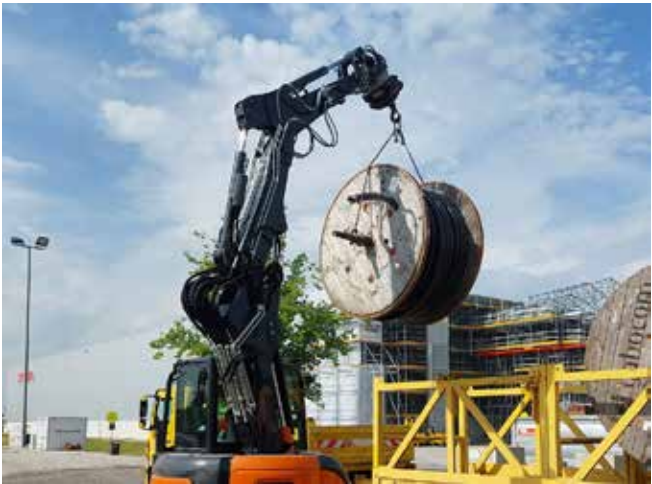
Flexible Lastaufnahme aus jeder Position Dank 360° Drehfunktion können Materialien kontrolliert aufgenommen und bewegt werden.
