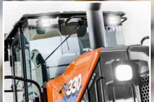
Die LED-Arbeitscheinwerfer verbessern die Sicht bei schwacher Ausleuchtung, des Vorfelds.
