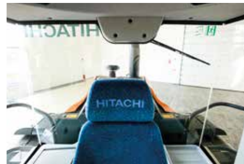
Die Sicht nach hinten wurde durch konstruktive Anpassungen verbessert.
