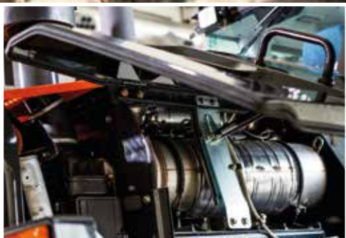
Das SCR-System reduziert Emissionen und den Lärmpegel.
