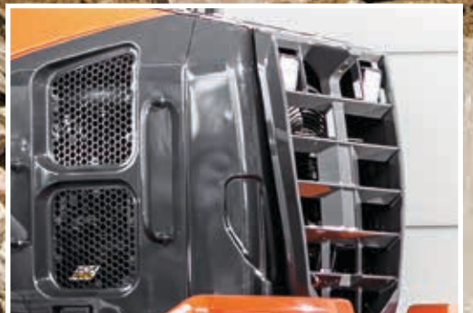
Optionale grobmaschige Kühler verlängern die Einsatzdauer und reduzieren die Reinigungsintervalle.
