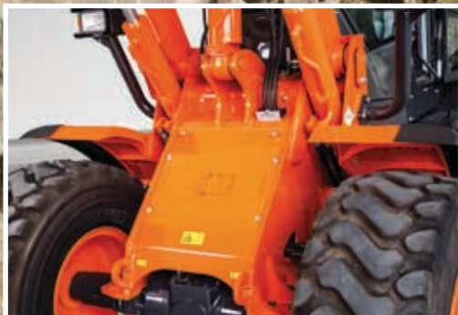
Der Vorderrahmen des ZW150-6 wurde verstärkt.
