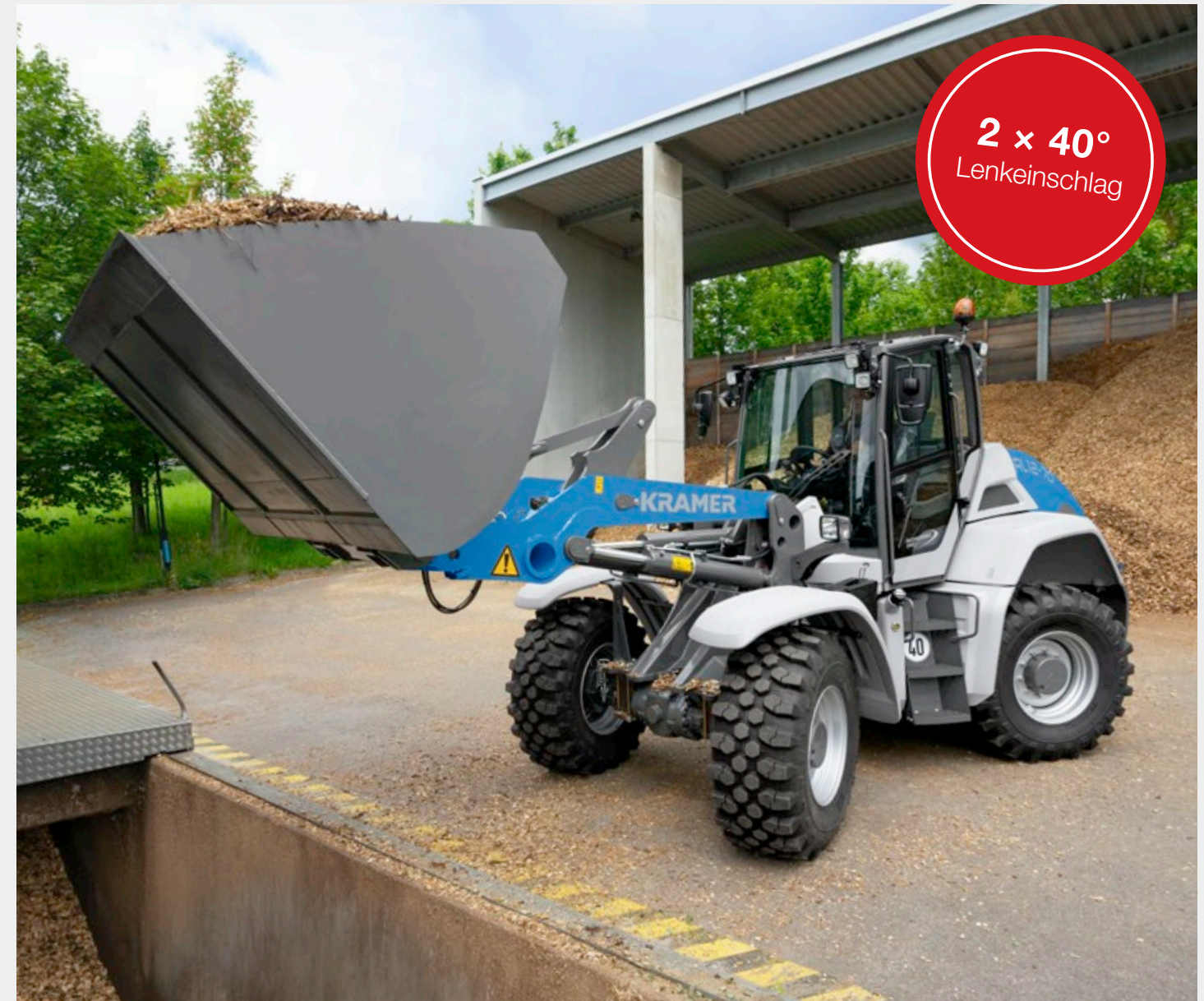
Allradlenkung besonders wendig bei eingeschränktem Platz
