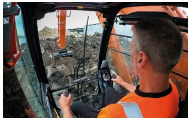
Das breite Parallelwischer-Konzept bietet eine bessere Sicht.
